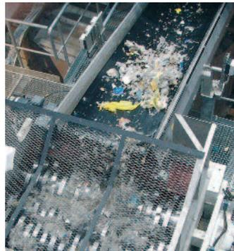
Mit Hilfe der Maschinenteknik von Erdwich werden die Reststoffe auf eine Größe von unter 50 mm zerkleinert und dann in Kraft-Wärme-Kopplungs-Anlagen verfeuert. Von dort aus gelangt die Energie wieder zurück zu den Papierfabriken.
