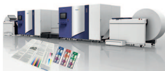
Screen führt auf den Hunkeler Innovationdays den 225 m/min schnellen Truepress Jet 520NX AD vor
