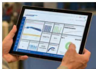
Das Dashboard der Connex Info Cloud, einem Modul des Connex-Workflow-Systems, bietet einen klaren Überblick über die gesammelten Daten. Es kann sowohl die eingebundenen Maschinen und deren Status als auch die aktuell bearbeiteten Aufträge anzeigen.
