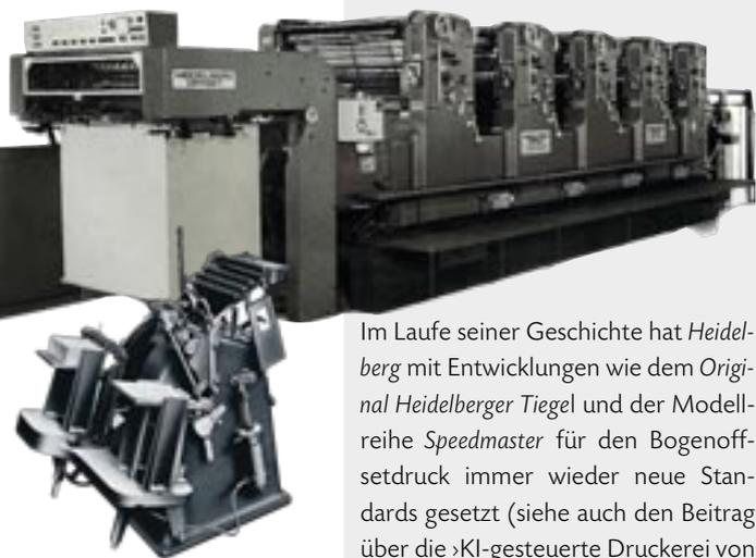
**Der 1921 vorgestellte Tiegeldruckautomat war mit 3.000 Bogen pro Stunde Druckleistung Best- und Longseller von Heidelberg. 1974 wurde die Bogenoffset-Baureihe Speedmaster mit einer Geschwindigkeit von 11.000 Bogen pro Stunde präsentiert, die bis heute die führende Marktstellung des Unternehmens untermauert.**
