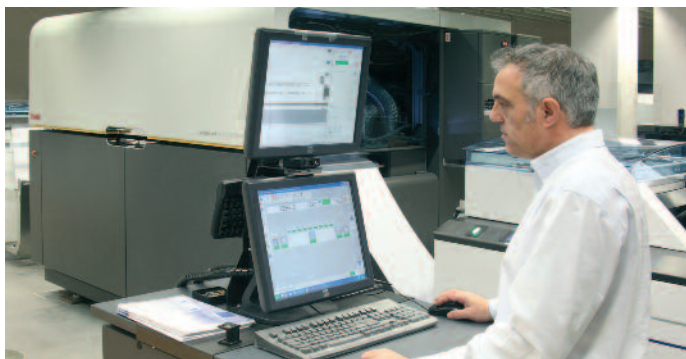
Mit einem Kodak Versamark VL6000 Drucksystem hat die Credit Suisse im Züricher Print Center die Inkjet-Farbdruckkapazität verdoppelt.
