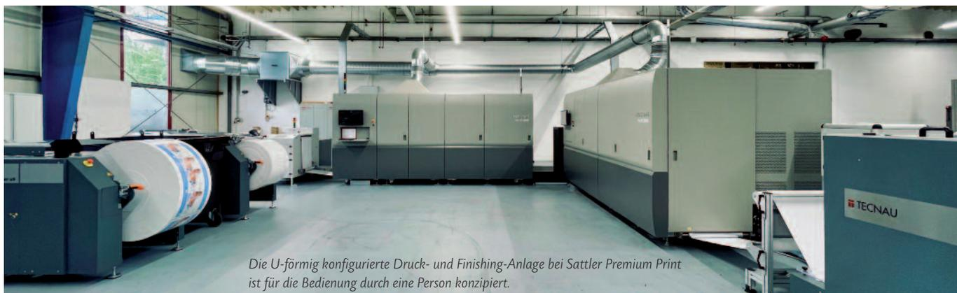
Die U-förmig konfigurierte Druck- und Finishing-Anlage bei Sattler Premium Print ist für die Bedienung durch eine Person konzipiert.
