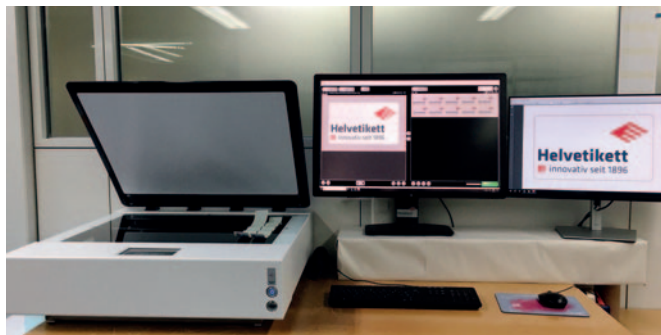
Bereits seit 2006 setzt die Helvetikett AG das scannerbasierte Inspektionssystem EyeC Profiler 600 DT im A2-Format in der Qualitätssicherung ein.
