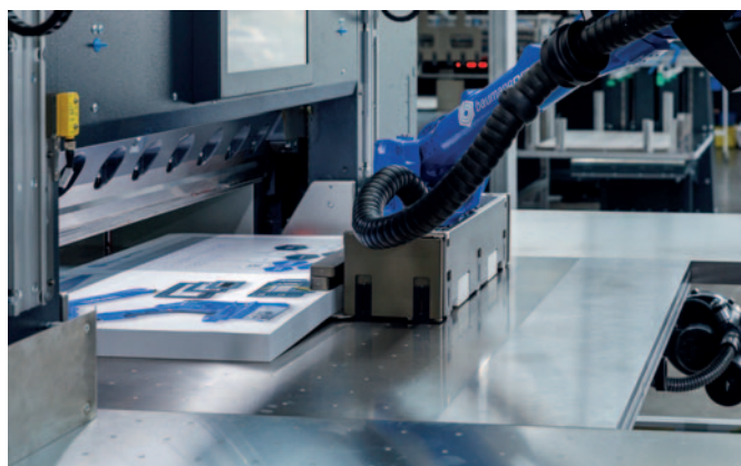
Der Roboter ist mit einem von Baumann speziell für die Papierverarbeitung entwickelten Greifersystem ausgestattet.
