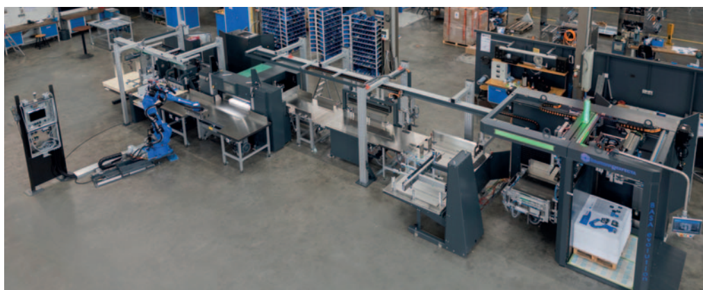
Eine zentrale Säule des baumannperfecta -Portfolios: Das vollautomatische Schüttel- und Schneidesystem kombiniert einen Schüttelautomat der neuesten Generation (rechts) und ein robotergestütztes Schneidesystem (links).
