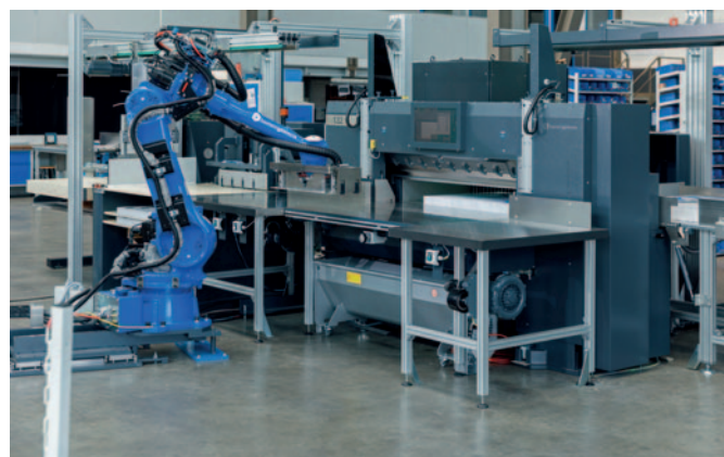
Ein Roboter Motoman GP50 von Yaskawa übernimmt an der Schneidemaschine das Handling des Papierstapels und kann dabei das Fingerspitzengefühl eines menschlichen Bedieners simulieren.
