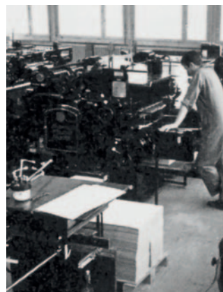
In der Satzabteilung wurde bis in die 1970er-Jahre mit Bleibuchstaben gesetzt, bevor der Offsetdruck Einzug hielt. Im Drucksaal wurde in den 60er- bis 80er-Jahren mit Heidelberger Buch- und Offsetdruckmaschinen gearbeitet.
