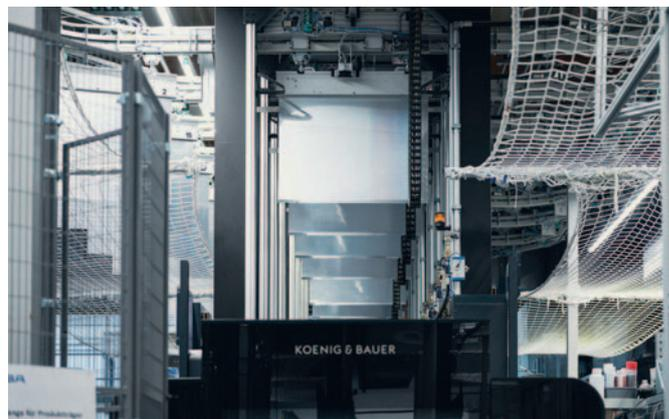
Druckplattenlogistik in Bereitschaft für einen vollautomatischen Jobwechsel.
