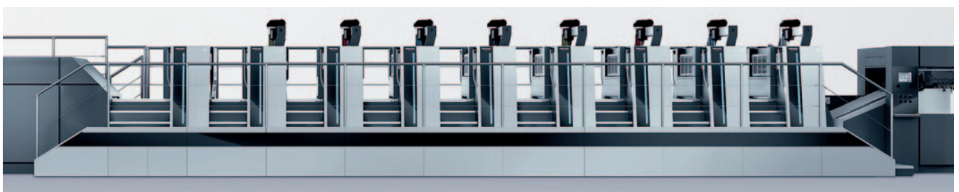
Die Druckwerke einer Speedmaster XL 106 8 L mit InkStar, AutoPlate und Coating. Mit einer Maschine dieser oder ähnlicher Konfiguration und den Versafire sowie Jetfire-Digitaldruckmaschinen will Heidelberg den hybriden Druck befördern.
