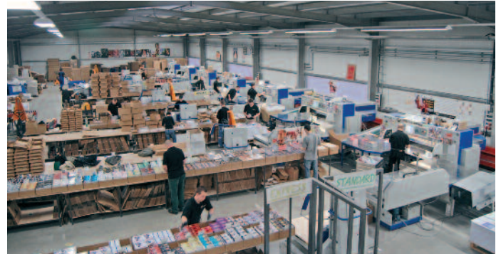
An sieben Schneidemaschinen werden die Sammelformen aufgeschnitten und gemäß der Bestellungen verpackt.
