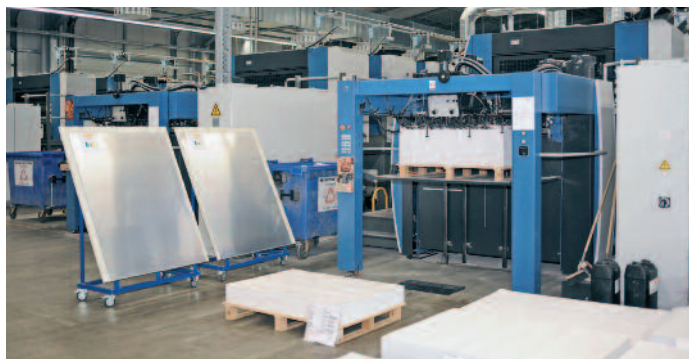
Die Logistik muss stimmen. An den Anlegern der Rapida-Jumbos stehen bereits Papier und Platten für die Folgeaufträge.
