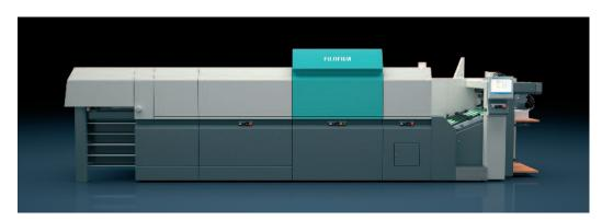
Die Basis der Jet Press 720 von Fujifilm ist vergleichbar mit der einer Bogenoffsetmaschine mit Anleger und Auslage. Das Papier wird jedoch statt durch vier Drucktürme nur über einen Zylinder zu den Inkjet-Druckköpfen geführt und danach direkt einem Trocknungssystem übergeben. Dabei sind die Ausmaße der Maschine mit 7,30 m Länge und 2,7 m Breite durchaus im platzsparenden Bereich.
